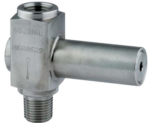
Projetado para proteger os manômetros e pressostatos de circuitos que podem gerar sobrepressões elevadas. Por causa acidental da pressão supera o valor máximo admitido, o limitador exclui automaticamente do circuito ao instrumento e o reingressa automaticamente quando a pressão do processo retorna normal. A pressão de intervenção é controlada entre um amplo intervalo.
